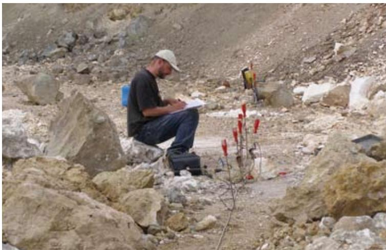
a.o. Prof. Dr. Erich Niesner bei geoelektrischen Messungen zur Sondierung mineralisierter Strukturen im Magnesitbergbau Tin utluca, westlich von Eskisehir in der Türkei.
