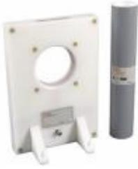
**Abbildung 15:** Bartington MS2C Sensor (aus Bartington Operation Manual).
