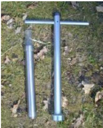
**Abbildung 13:** HUMAX Schlagsonde mit einem Durchmesser von 35mm (aus <http://www.humax.ch/produkte/handsondensch/index.php>).
